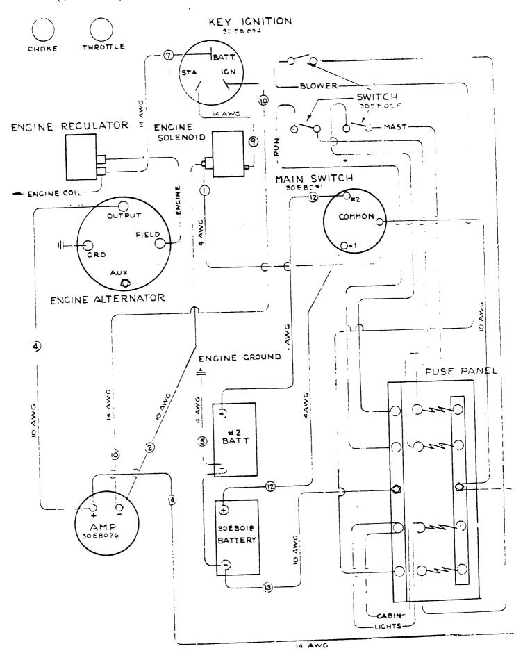
SHIPS ELECTRICAL SYSTEM IS 14 AWG
